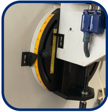
(ZIVANA KANALI AÇISI / MORTISING ANGLE)
